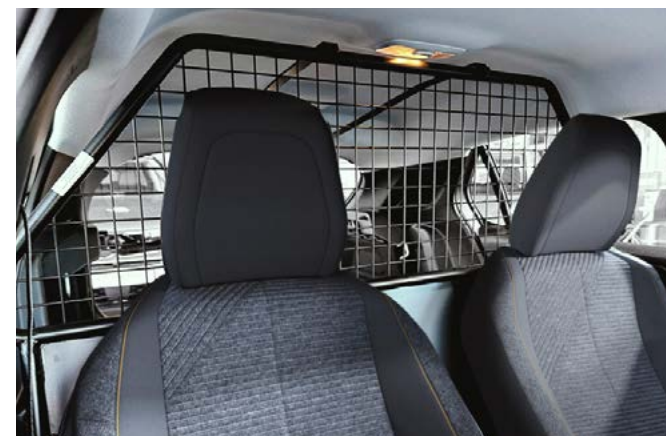
PRZEGRODA. Wytrzymała kratka zabezpieczająca przedział osobowy jednocześnie dająca możliwość pełnego odsunięcia foteli.
